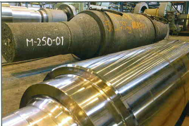
Mecanizado con las plaquitas de CERATIZIT: los cilindros de Åkers que cuyo peso alcanza hasta sesenta toneladas.
