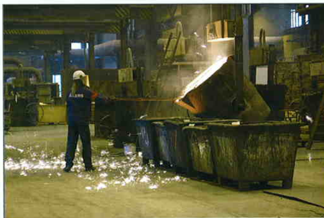
Un "fuego artificial": una operaria de Åkers controla la temperatura del hierro fundido antes de la colada.
