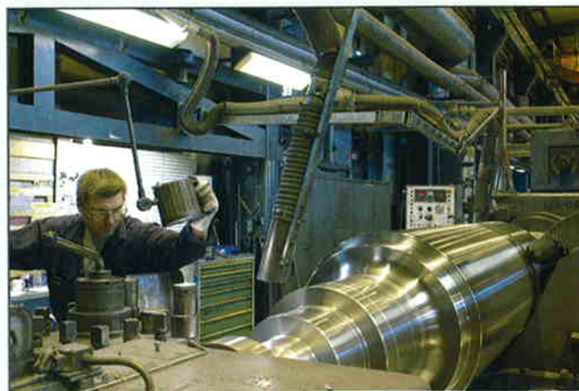
En el copiado se exige absoluta concentración. Una falta de atención, por pequeña que sea, y el cilindro de 60 toneladas se ha convertido en chatarra.
