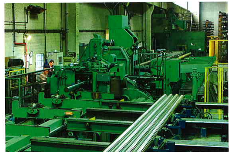
Gigantisch: Das Schäl-drehen bei BGH in Siegen übernimmt eine über 50 Meter lange Kieserling-&-Albrecht-Anlage, die bis zu 18 Meter lange Stangen bearbeiten kann.
