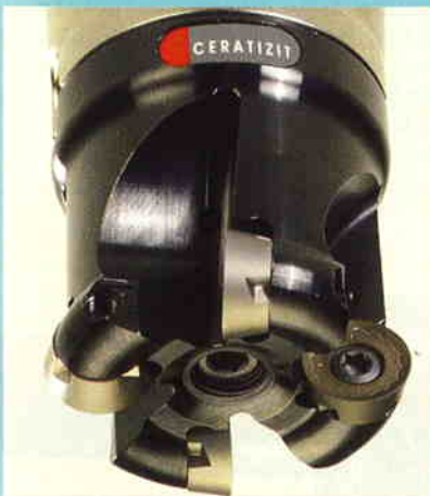
Durch die CERATIZIT-Rundplattenfräser »MaxiMill 251« und »-M31 CTC5235«-Wendeschneidplatten mit HyperCoat-Beschichtung konnten die Schnitttiefe um 50 % erhöht und die Standzeit verdoppelt werden.
