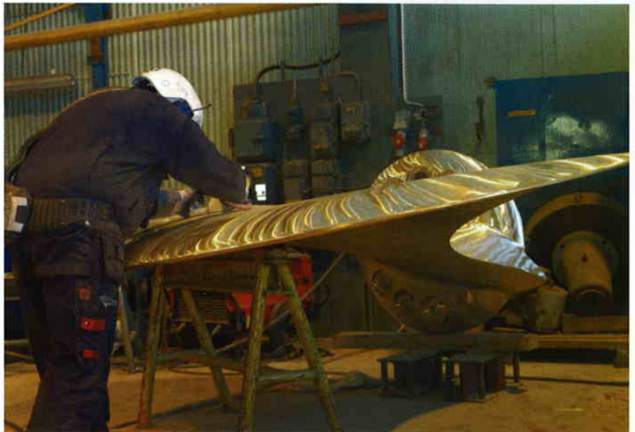
Richtiges Polieren und Auswuchten verlangt Geschicklichkeit und Erfahrung.
