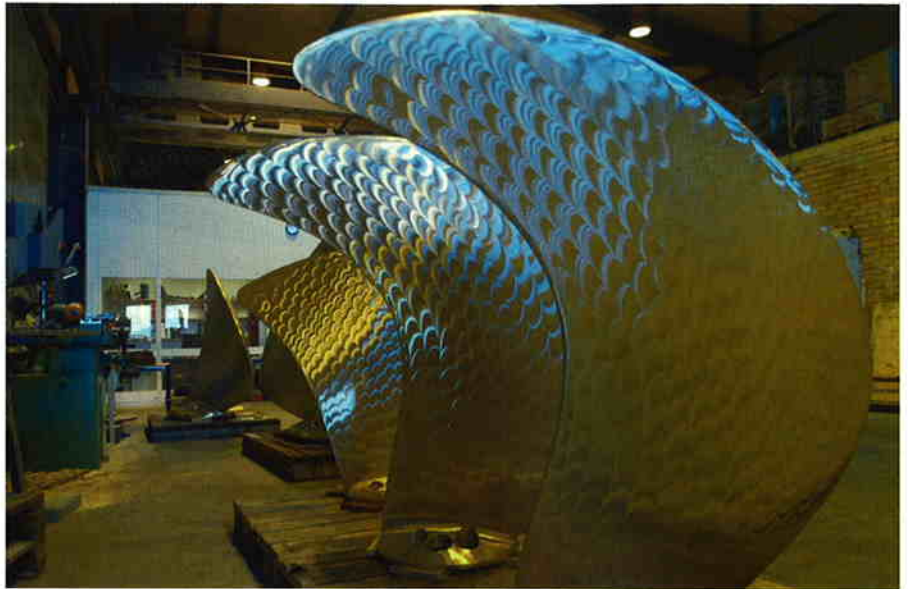
Die Propellerschaufeln verfügen über ein hydrodynamisches Flügelprofil. Die Schaufeln wiegen zwischen 80 Kilo und fünf Tonnen. Propeller für Schiffe, die sich einen Weg durchs Eis bahnen müssen, sind sogar meist aus rostfreiem Stahl.
