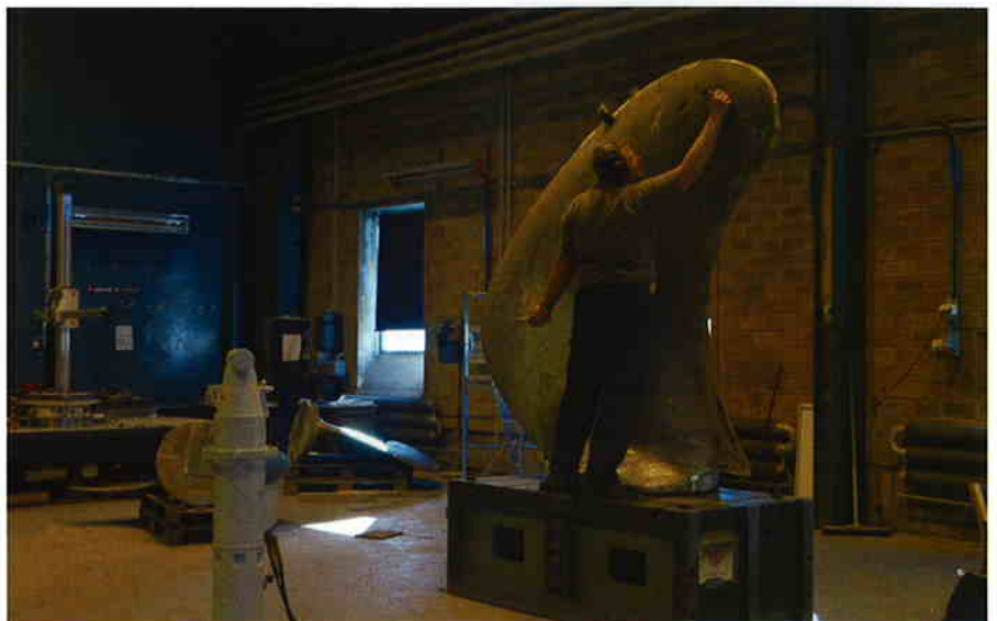
Ein Mitarbeiter von Aerodyn misst die gegossene Schaufel aus und legt fest, wie sie zu fräsen ist.
