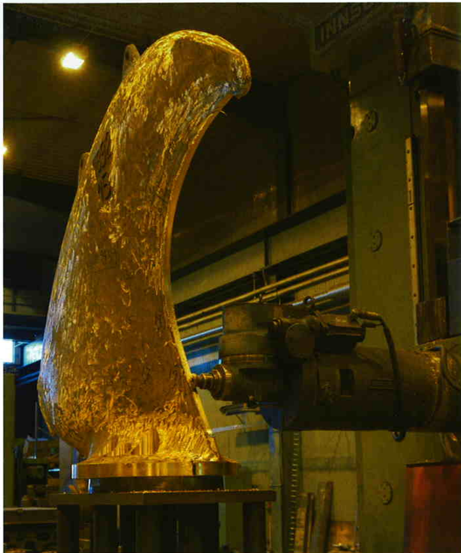
Bei einem Schaufelgewicht von 3,8 Tonnen liegt die Toleranz zwischen den Schaufeln bei nur sechs Kilogramm. Fotos: CERATIZIT S.A.
