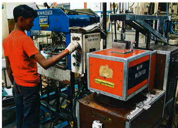
Metaldyne-Mitarbeiter beim Wuchten eines Schwungrades
