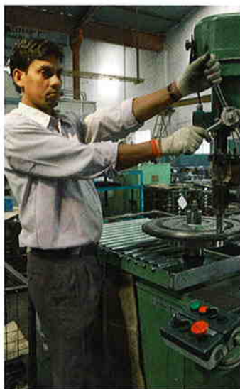
Metaldyne-Mitarbeiter beim Wuchten eines Schwungrades
