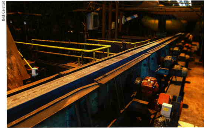
Die Brammen oder Stahlknüppel kommen vom Stahlwerk und sind auf dem Weg zum Spezialofen,
