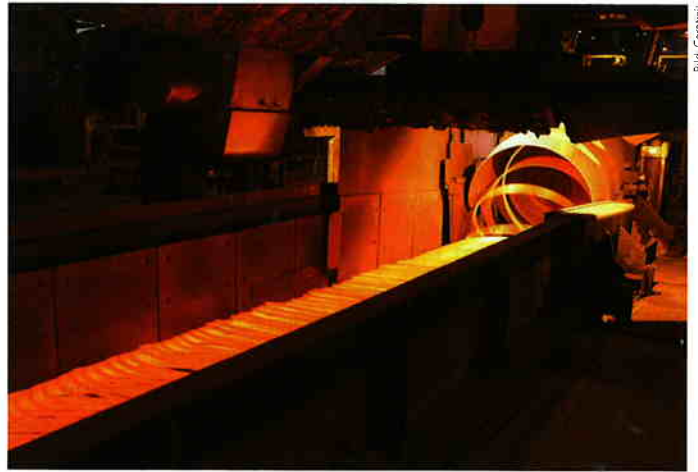
Der noch glühende Draht verlässt die Walzanlage.
