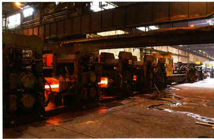
In mehreren Schritten formen die Walzen den glühenden Stahl um,
