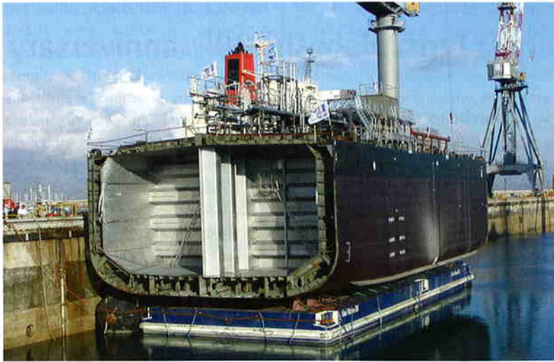
Innenverkleidung aus rostfreiem Stahl in einem Tanker für den Transport von chemischen Stoffen
