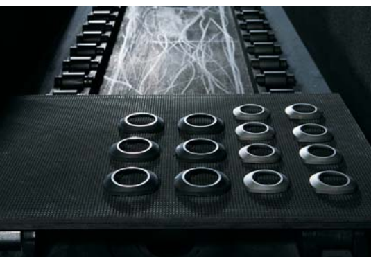
Hartmetallgehäuse von Ceratizit für den Schweizer Uhrenhersteller Rado: Gespritzte Teile vor dem Sintern.
