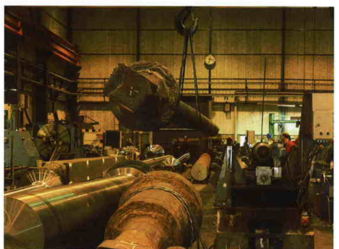
Die Grobzerspanung einer Propellerwelle dauert zwischen 15 und 30 Stunden. Bild: Ceratizit S.A.
