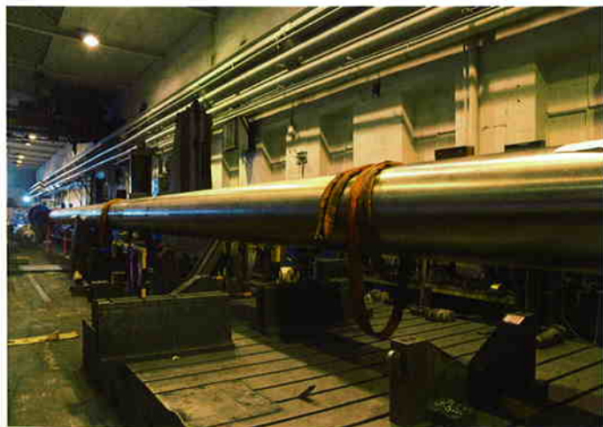
Zum Drehen seiner Wellen – diese ist 25 Meter lang – setzt Scana fünf Wendepfannen und Werkzeuge von Ceratizit. Bild: Ceratizit S.A.
