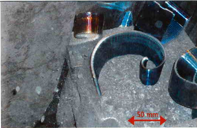
3 Drehen in gehobenen Dimensionen: Spanbildung beim Plandrehen einer Generatorwelle
