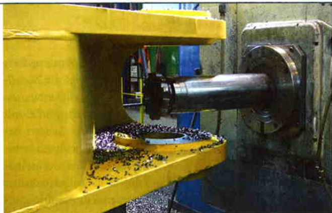
5 Bearbeitung einer Aufnahme an einer Schweißkonstruktion
