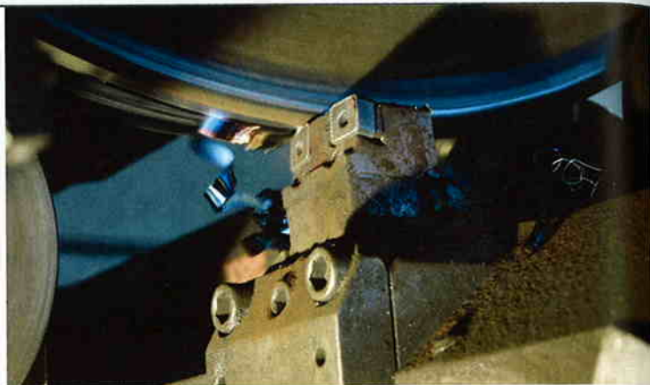
2 Prozesssicherheit und idealer Spanbruch haben Vorrang: Radsatznachbearbeitung auf einer Unterflurmaschine
